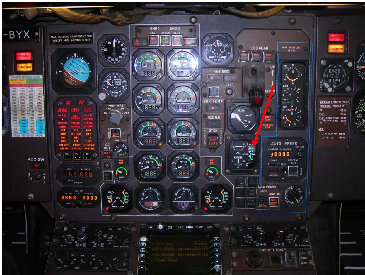
Рисунок 59 Панель приборов с указанием положения триммера PВ
