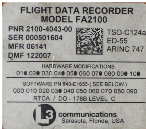
Рисунок 8 Этикетка с маркировкой параметрического регистратора.
