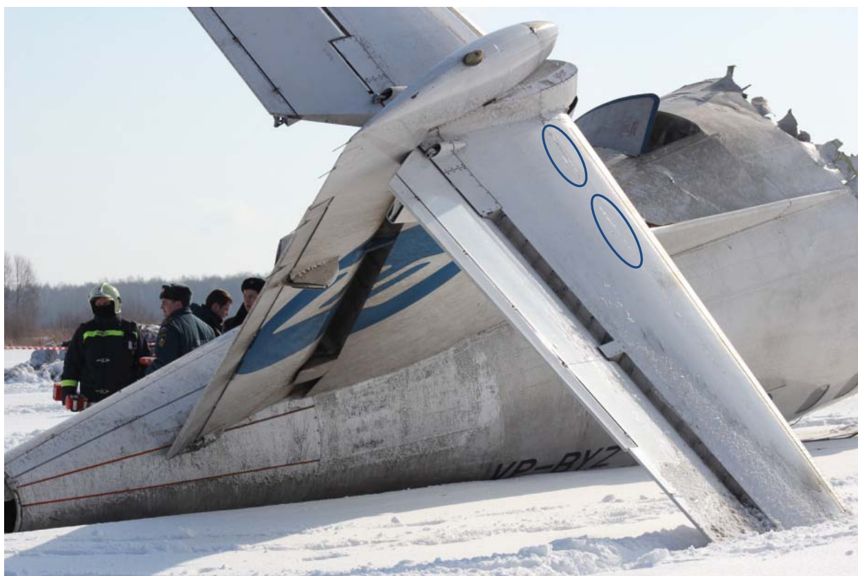
Рисунок 1 Правая половина стабилизатора со следами снежно-ледяных отложений
