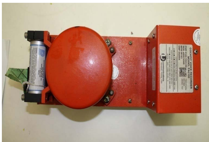
Рисунок 5 Бортовой аварийный звуковой регистратор FA2100 SN000274566
