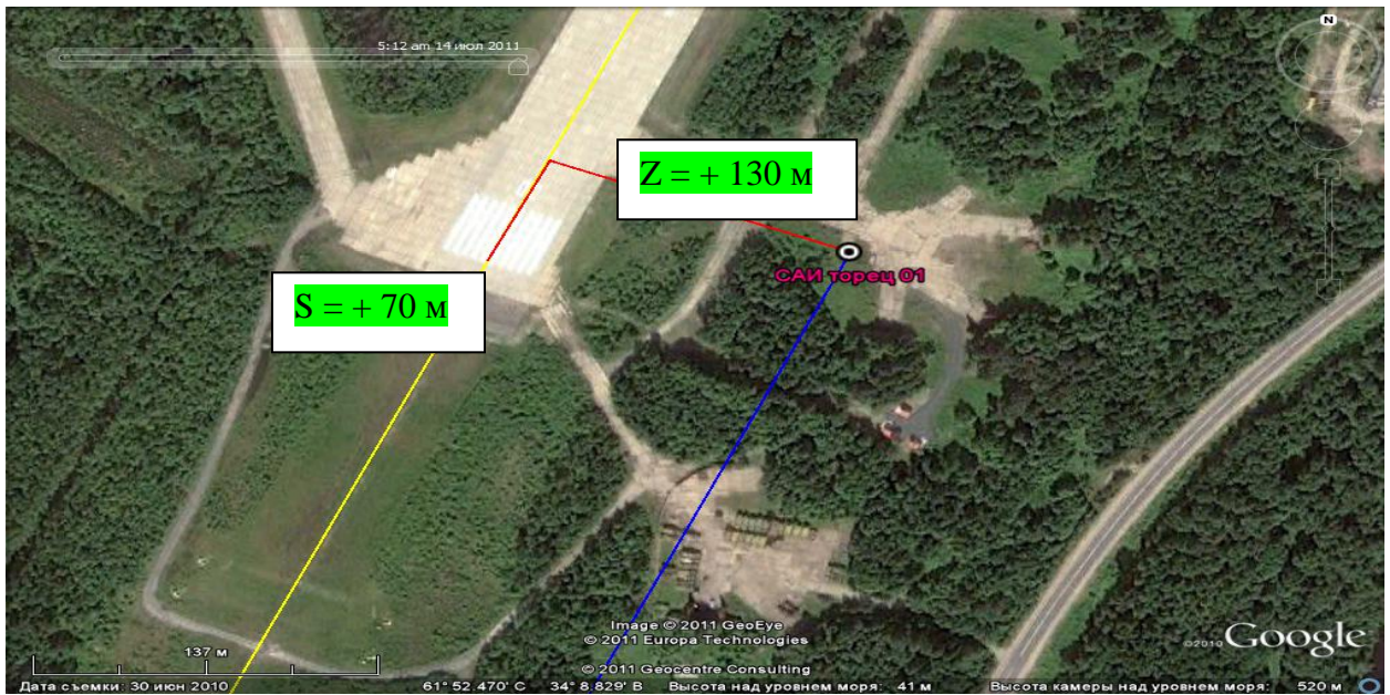
Рис. 5. Смещение торца ВПП с MK_{\text{пол}}=12^\circ при использовании координат в системе СК-42 Z (боковое расстояние от оси ВПП) = 130м. S (продольное расстояние от торца ВПП) = 70м
